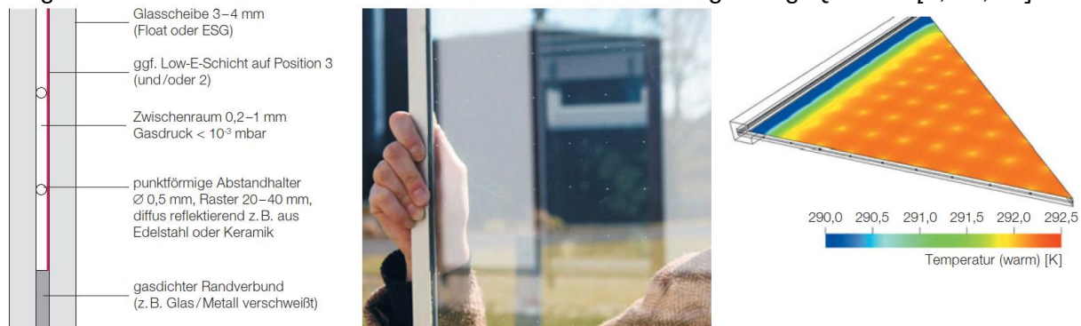
Abb. 37: Einige Details eines Vakuumglases, von links nach rechts: Querschnitt, Fotografie und thermische Bewertung. [1]
